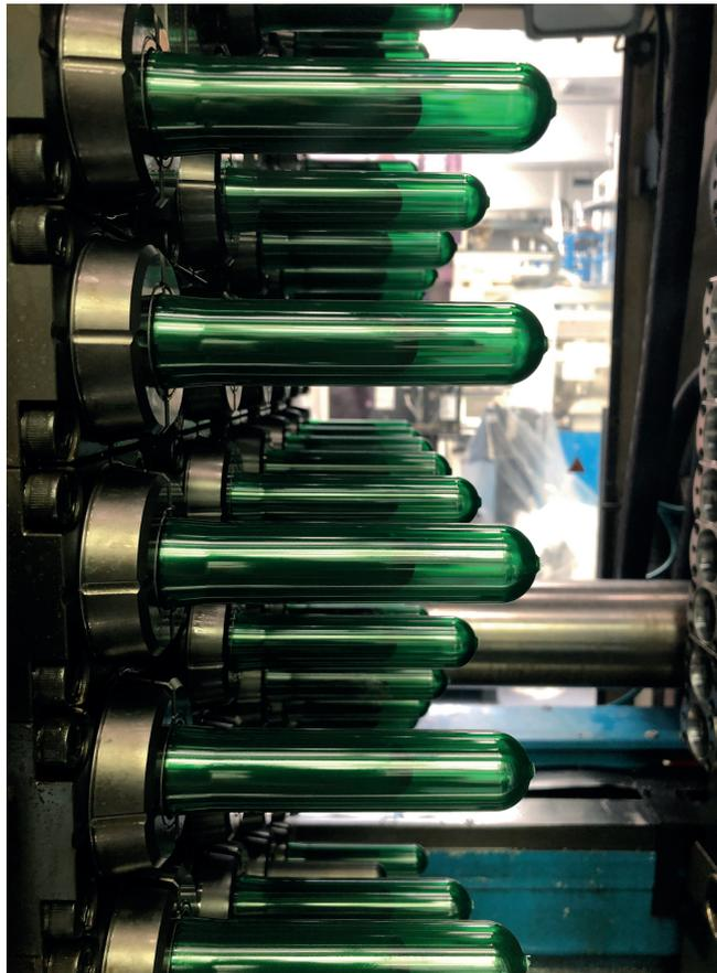
Multi-Kavitäten-Werkzeug zur Herstellung von Preforms für PET-Flaschen
